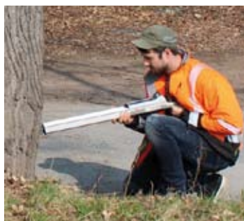
Bruchfestigkeitsprüfung einer Buche mit Resistografen
